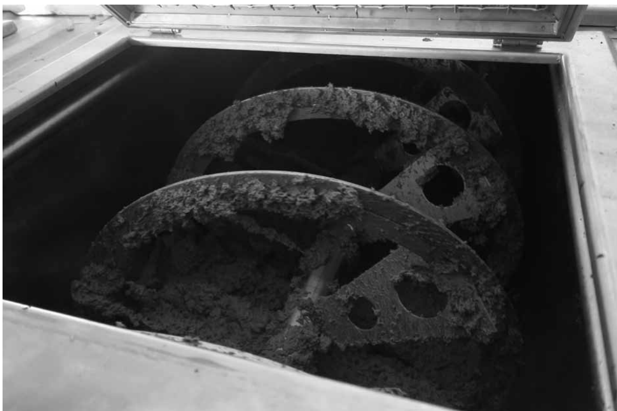
Im Mahlwerk: Auf mehr als unter 27 Grad Celsius darf sich das Olivenöl beim Pressvorgang nicht erwärmen.
